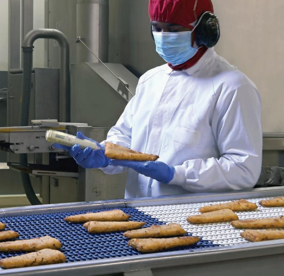
Contrôle de la température à cœur en sortie de cuisson.
